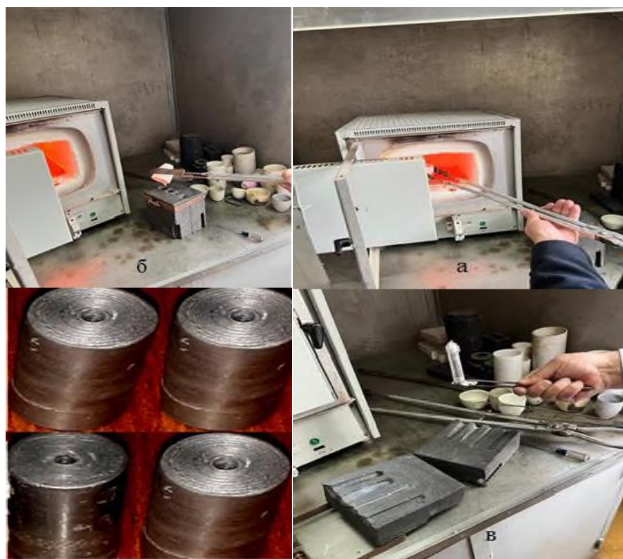
Рисунок 1 –Процесс получения сплавов: а-плавление шихты в муфельной печи, б-литьё образца в графитовой изложнице, в-извлечение образца из изложницы, г-готовые образцы для исследования
