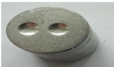
Рисунок. Фотографии образцов после испытания на твердость алюминиевого проводникового сплава AlV0.1.
