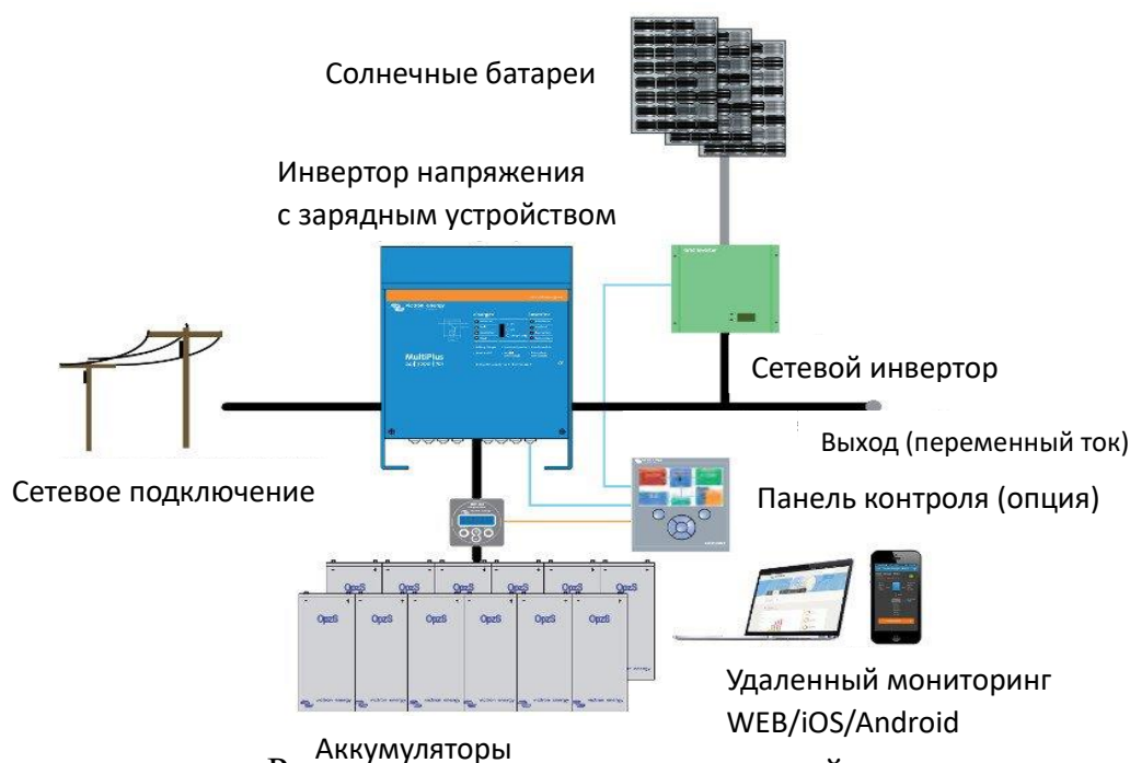
Рис. 3. Схема гибридной солнечной электростанции
