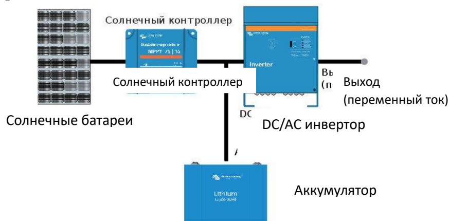
Рис. 2. Схема солнечной электростанции на переменном токе.
