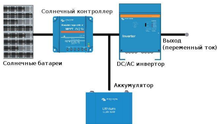
Рис. 2. Схема солнечной электростанции на переменном токе.
